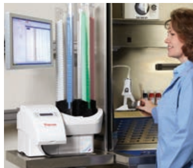
PrintMate AS Kassettendrucker, abgebildet mit optionalem All-in-one-PC und Digital Imager.
